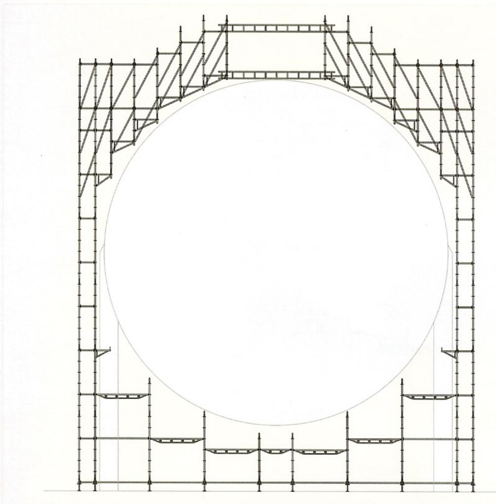
Numa esfera o sistema ADAPT permite os trabalhos na sua superfície sem qualquer tipo de ligação adicional.
